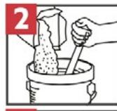
Agregue gradualmente un bulto (10 kg) de Adhesivo Piso sobre Piso 1.5®, mientras mezcla hasta obtener una pasta suave y sin grumos.
