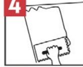
Con el lado liso de una llana metálica, aplique una capa delgada de adhesivo sobre la superficie haciendo presión.
