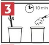
Deje reposar la mezcla 10 minutos, esto activará los componentes adhesivos de la mezcla.
