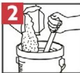
Agregue el contenido del saco poco a poco hasta que el polvo se integre con el agua, mientras mezcla hasta obtener una pasta suave y sin grumos.
