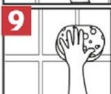
Retire el adhesivo fresco de entre las piezas. Solo se necesita agua para remover el producto antes de que se seque.
