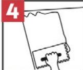
Con el lado liso de una llana metálica, aplique una capa delgada de adhesivo sobre la superficie haciendo presión.
