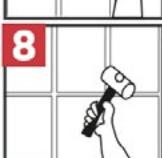
Golpee ligeramente las piezas con un mango de madera o mazo de goma para ajustar cada una en su lugar, hasta hundir una cuarta parte de la pieza en el adhesivo.
