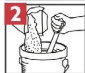
Agregue el contenido (20 kg) de Adhesivo para Cerámica 1.1® poco a poco hasta que el polvo se integre con el agua, mientras mezcla hasta obtener una pasta suave y sin grumos.
