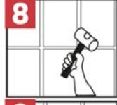
Golpee ligeramente las piezas con un mango de madera o mazo de goma para ajustar cada una en su lugar, hasta hundir una cuarta parte de la pieza en el adhesivo.
